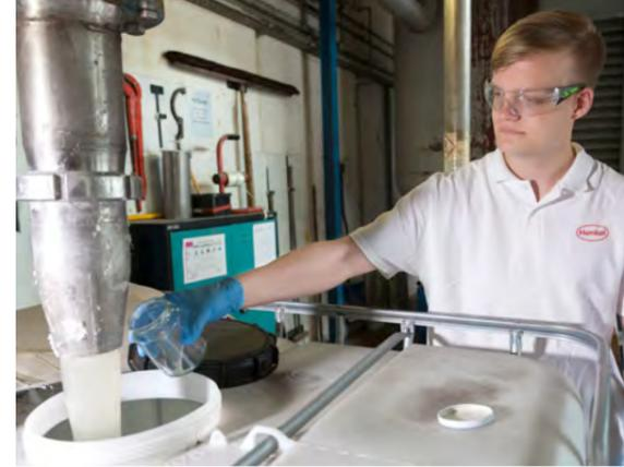
Bernd Fulle zieht eine Probe des klebeaktiven Bestandteils, der für die Herstellung des Pritt-Stifts benötigt wird.
