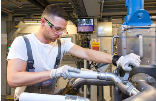
Chemikant Denis Brug befüllt den Extruder mit dem Füllstoff Kreide, einem von zwölf Inhaltsstoffen des Klebstoffs „Flextec“.
