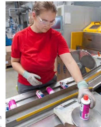
Bei einer Stichprobe wiegt Angela Ulrich eine mit Klebstoff fertig abgefüllte Kartusche.
